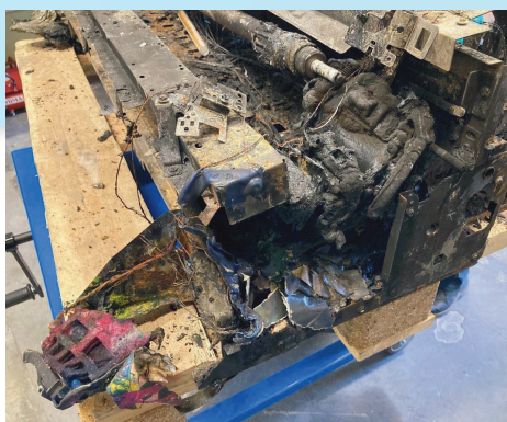
Brandbedingt völlig zerstörter Digitaldrucker.
